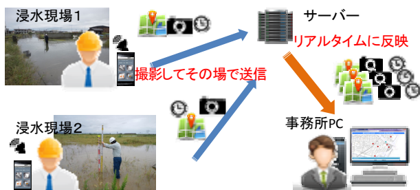
浸水状況調査をリアルタイムに事務所で確認する概念図
