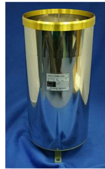
写真-5 クリマテック社の転倒ます雨量計 (日本製) 一転倒で 0.5 mm の雨量が計測できる。
