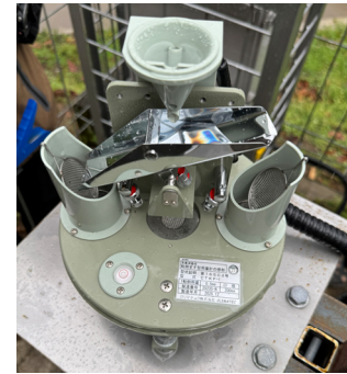
写真-5 クリマテック社の転倒ます雨量計 (日本製) 一転倒で 0.5 mm の雨量が計測できる。
