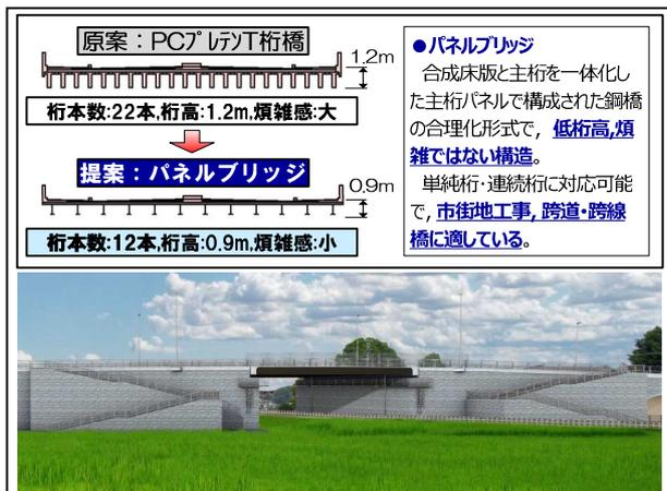
図-3 橋梁部の構造形式(パネルブリッジ)
