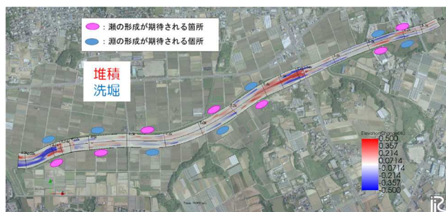
図-4 整備後河道の河床形態の予測
