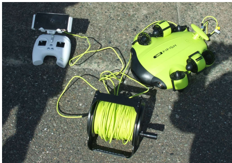
写真-1 全数点検に使用した ROV と周辺機器
