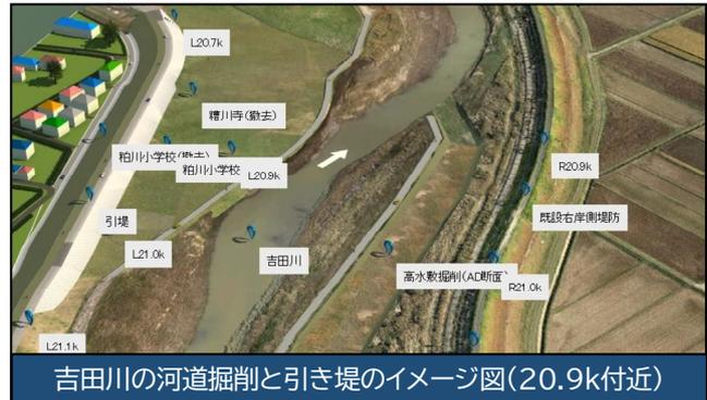
吉田川の河道掘削と引き堤のイメージ図(20.9k付近)
