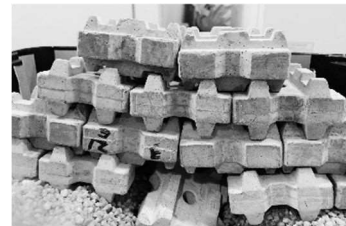
写真-2 観察されたブロック積砂防堰堤における屈撓性能の状況
