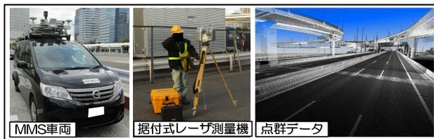
図-3 3次元レーザ測量
