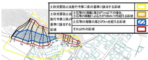
図-2 住民説明会に用いる土砂災害警戒区域等 5) 設定図の一例
