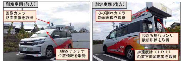
写真-2 路面性状調査車両(機器性能)
