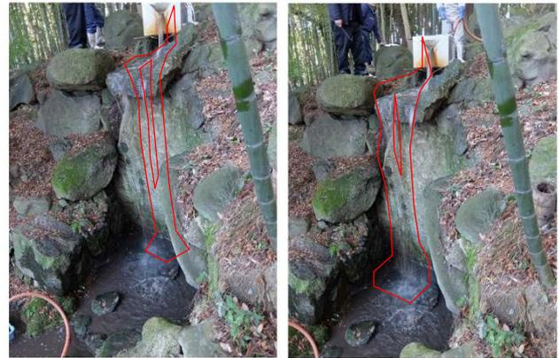
図-3 大滝の落水実験(左: 60L/min、右: 90L/min)
